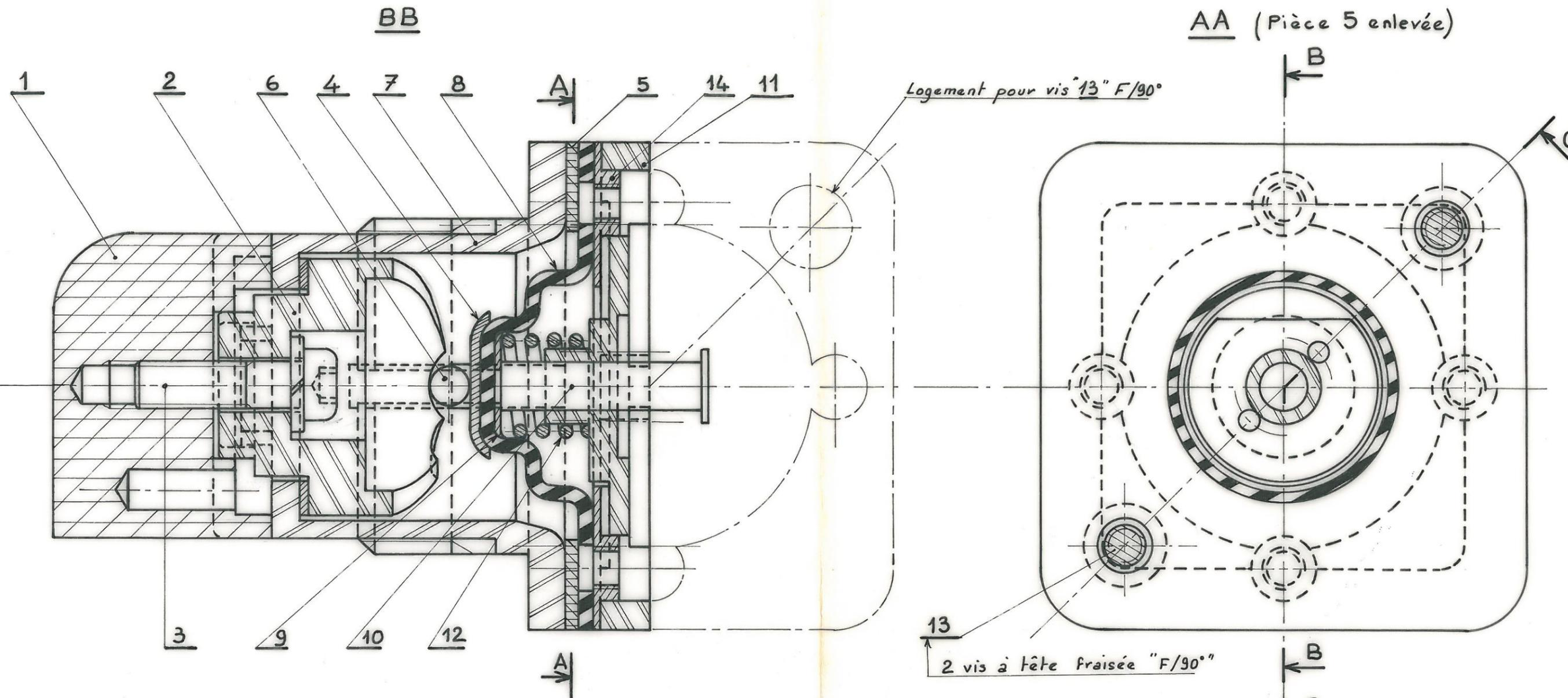
L'ensemble représente à l'échelle 3 un commutateur rotatif "TELEMECANIQUE X B2-M" à 3 positions qui permet l'établissement de deux circuits avec une position "arrêt".
